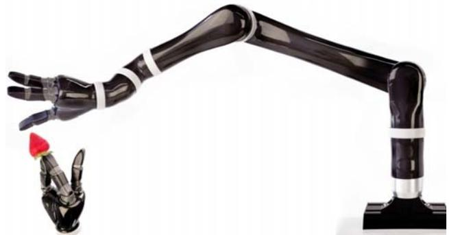
**ES-PM01-Bild01: Jaco Leichtbauroboter aus Kohlefaser mit präziser Dreifinger-Hand.**
